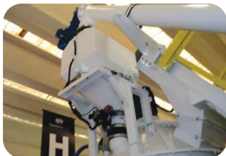
Sistema de Dosagem de Cimento
