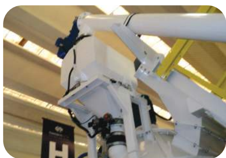
Sistema de Dosagem de Cimento
