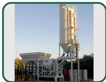
CWM Smart - Central Móvel Capacidade: 60 m 3 /h
