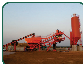
MBM Mixer - Central Misturadora Móvel Capacidade: 60 - 80 m 3 /h
