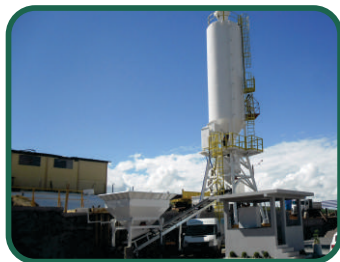
TGS - Central To Go Fixa Capacidade: 20 a 40 m 3 /h
