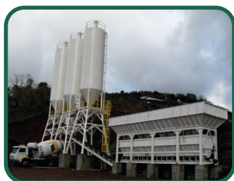
CWS - Central Fixa Pesagem Capacidade: 80, 100 e 120 m 3 /h
