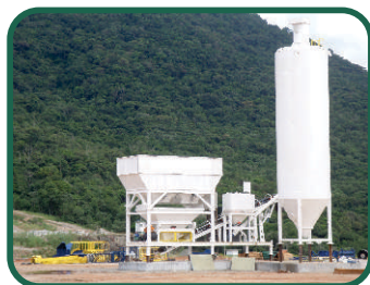
CWS Smart - Central Semimóvel Capacidade: 60 m 3 /h
