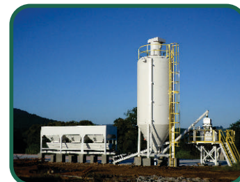
MSS Mixer - Central Misturadora Fixa Capacidade: 10 - 24 m 3 /h
