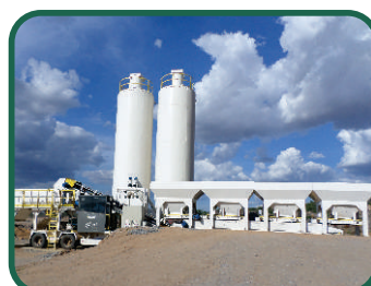
SCM Mixer - Central de concreto rolado móvel, solos e BGTC Capacidade: 200 - 500 t/h
