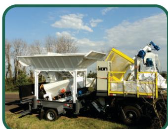
MSM Mixer - Central Misturadora Móvel Capacidade: 10 - 25 m 3 /h
