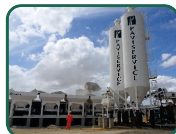
SCS Mixer - Central de concreto rolado fixa, solos e BGTC Capacidade: 200 - 500 t/h
